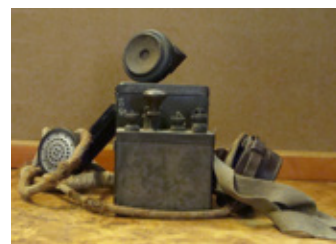
Téléphone de tranchées anglais avec manipulateur morse
