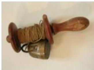
Doc 41 : fil à plomb réalisé dans un percuteur ; bois, ficelle et laiton 274
