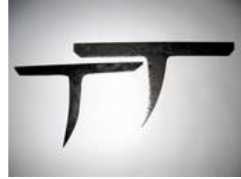
Doc 164 : enclumettes de couvreur : piquées dans un chevron, elles permettaient de retailler les ardoises 903
