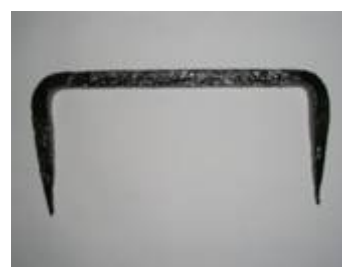
Doc 161 : serre poutre de charpentier : outil de montage des charpentes 900
