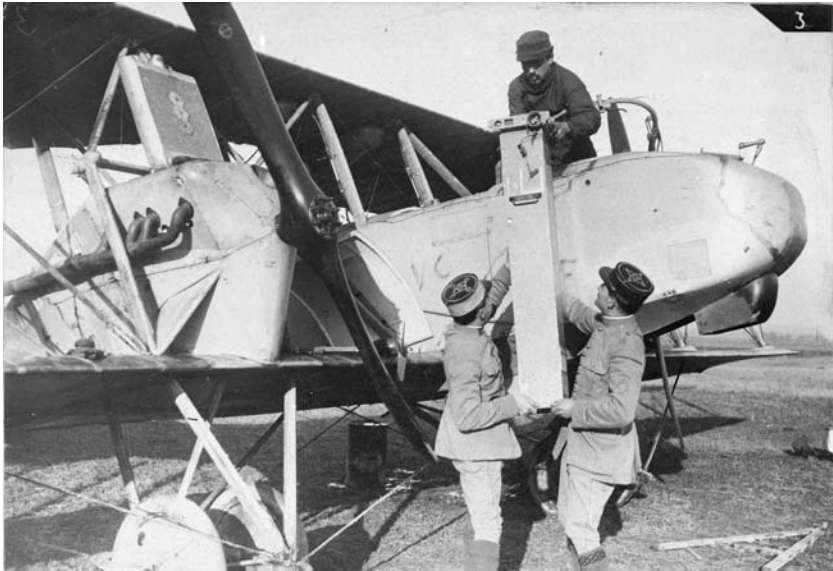
Montage d'un appareil photographique de prises de vues verticales à grandes focales à bord d'un Letord L.2. Coll. ministère de la Défense, Service historique.
