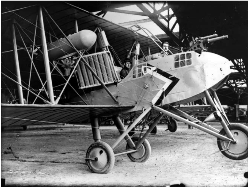
Breguet Michelin BM V, affecté au camp retranché de Paris, avec le pilote Pierre Perrin de Brichambaut aux commandes. L'appareil est armé d'un canon de 37 mm. Coll. ministère de la Défense, Service historique.
