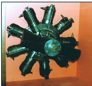
Moteur Gnome à 9 cylindres rotatif de 100 ch dit « monosoupape ». (Musée des Arts et Métiers).
