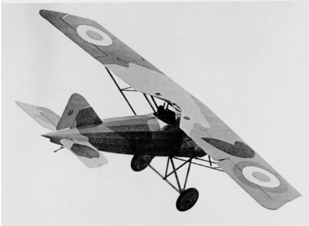
Le Morane-Saulnier AI à moteur Gnome 9N monosoupape de 165 ch (août 1917) fut refusé pour la chasse, sa vitesse à l'atterrissage étant excessive ! Les 1.210 exemplaires construits furent utilisés pour la formation des pilotes. (Cliché Amicale J.B. Salis).
